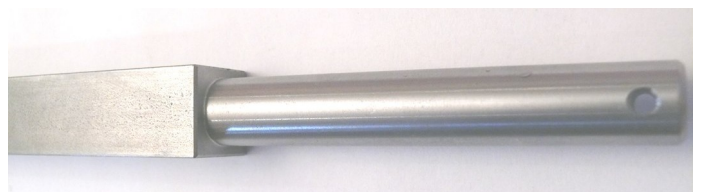
Achse verbessert, Achszapfen angedreht
