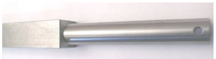
Achse verbessert, Achszapfen angedreht
